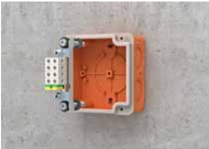
Atzīmē, izurb, pieskrūvē, gatavs - divas jau iemontētās enkurskrūves vienlaikus nostiprina kabeļu nozarkārbu.
